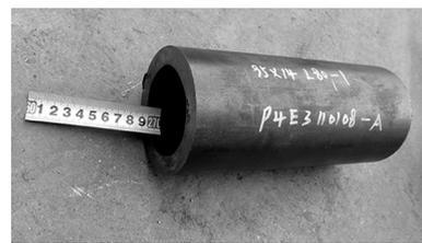
图4 石油套管锻坯外貌
