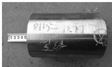
图3 表面有磁粉缺陷石油套管外貌
