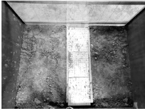
图8 涵洞—填料试验模型
